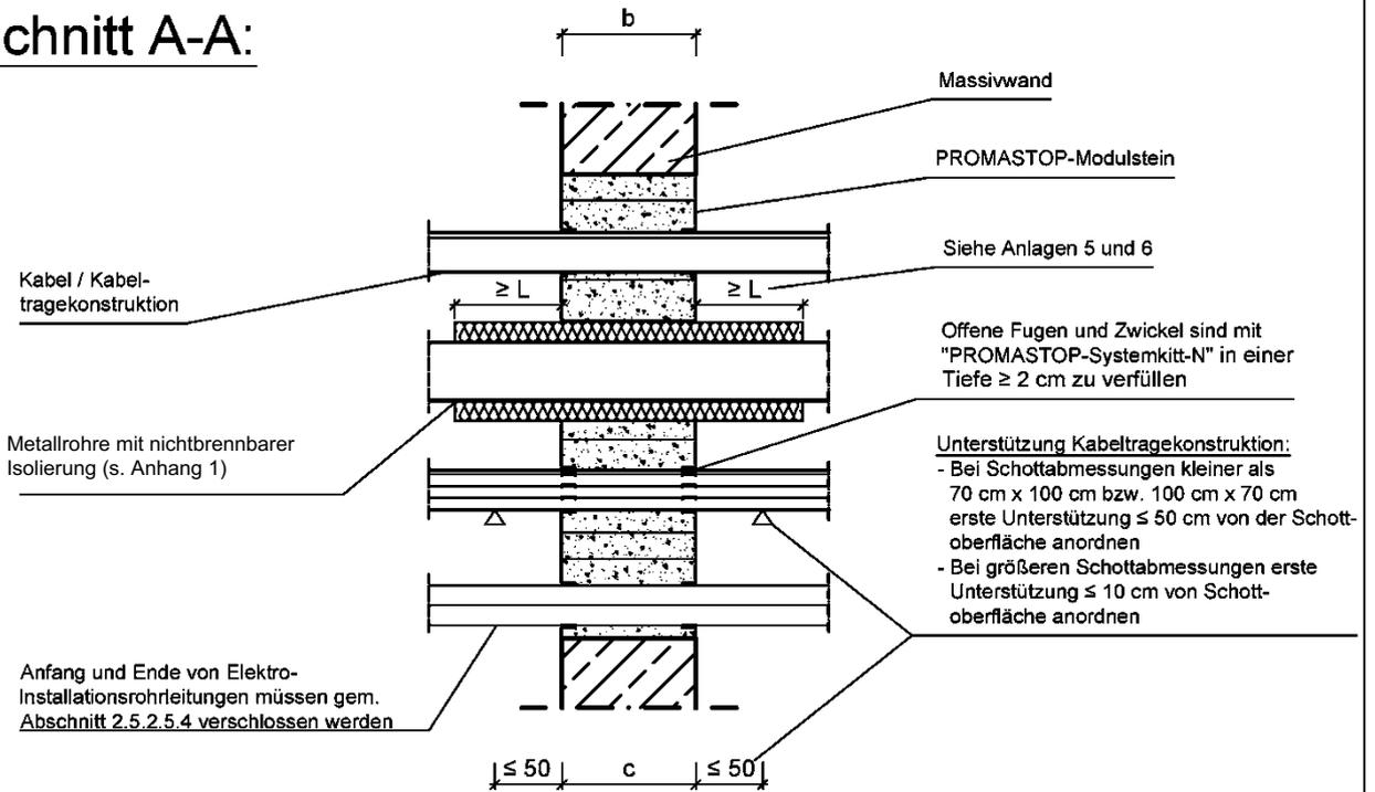
Anfang und Ende von Elektro-Installationsrohrleitungen müssen gem. Abschnitt 2.5.2.5.4 verschlossen werden
