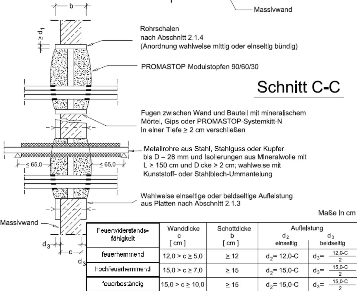
Feuerwiderstandsfähige Abschottung für elektrische Leitungen und/oder Rohrleitungen aus Metall "PROMASTOP-Kabelschott, Modulstopfen"
