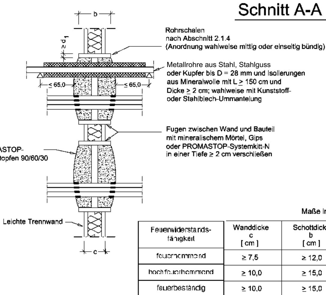
Feuerwiderstandsfähige Abschottung für elektrische Leitungen und/oder Rohrleitungen aus Metall "PROMASTOP-Kabelschott, Modulstopfen"
