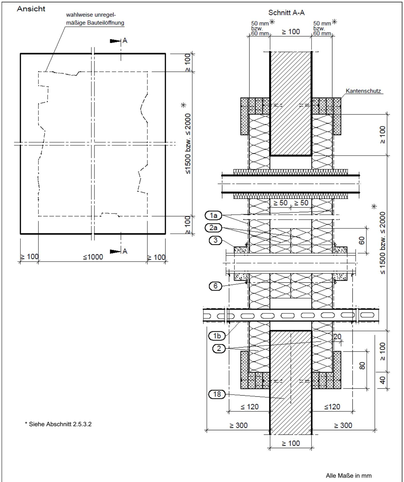
Feuerwiderstandsfähige Abschottung für elektrische Leitungen und/oder Rohrleitungen aus Kunststoff oder Metall "PROMASTOP-Kombischott 90, Typ E"
