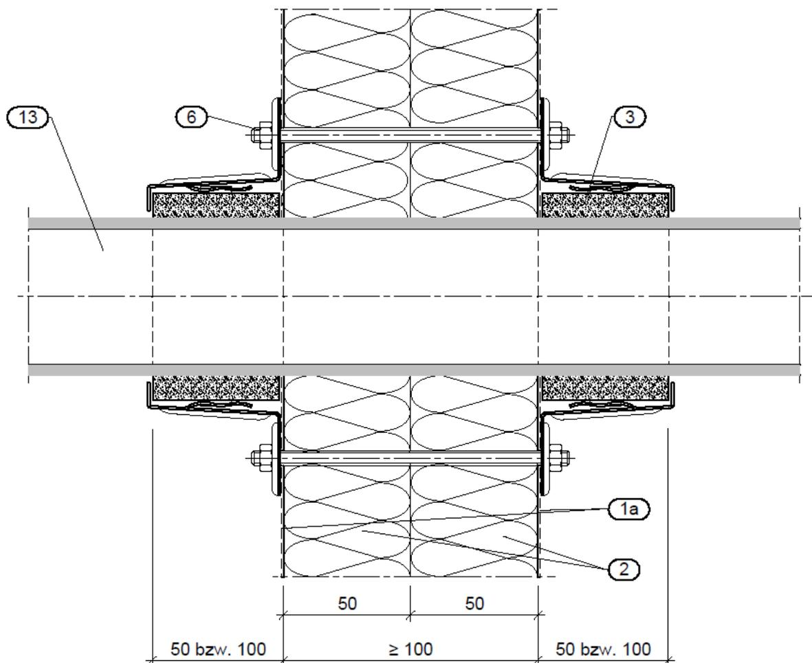
\* je nach Rohrmaterial und -durchmesser ein oder zwei Manschetten
