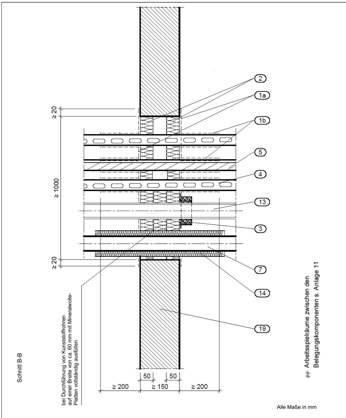
Feuerwiderstandsfähige Abschottung für elektrische Leitungen und/oder Rohrleitungen aus Kunststoff oder Metall "PROMASTOP-Kombischott 90, Typ E"
