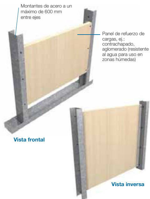
Refuerzo a estructura de muro en cargas previstas
