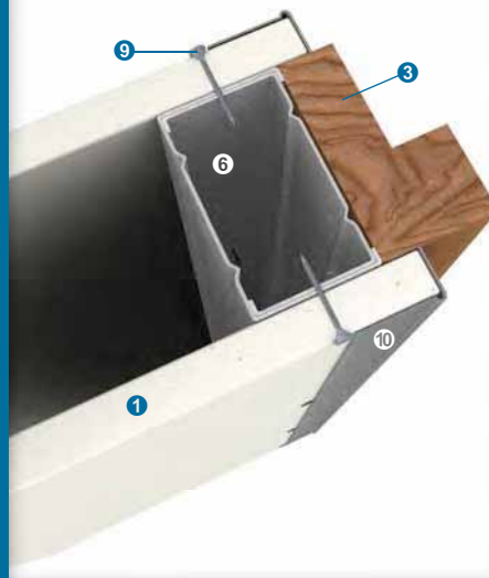
Detalles de instalación de marco de puerta (con travesaño de acero encuadrado)
