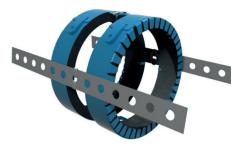
**3.** Bei Abständen von 32-63mm genügt die Verbindung mit einem Metallstreifen. Beträgt der Abstand 75-125mm, sind zwei perforierte Metallstreifen gegenüberliegend zu montieren.
