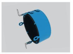
**6.** Schachtwandclips sind an jeder zweiten Lasche zu befestigen, bzw. an mindestens 50% der Laschen, z.B. an drei von fünf Laschen.
