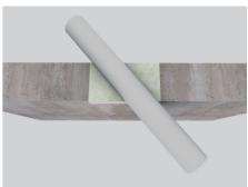
2. Der Ringspalt muss an der dünnsten Stelle mindestens 10mm betragen. Der Spalt ist über die gesamte Tiefe mit Brandschutzmörtel zu verfüllen.
