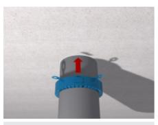
**5.** PROMASTOP®-FC ist nun mit den beiliegenden Schrauben an die Unterseite der Decke zu montieren.
