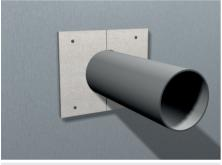
**4.** Die PROMATECT®-100 Plattenstücke sind mit 3,5 x 100 mm Schnellbauschrauben durch das Blech zu befestigen.
