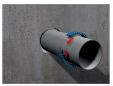
**3.** Die Brandschutzmanschette ist um das Rohr zu platzieren und der Verschluss zu schließen. Die Manschettenlaschen sind um 180° zu biegen.
