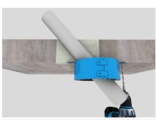
**6.** Die Brandschutzmanschette ist an allen Laschen an der Wand oder an der Decke zu befestigen. Es ist ein Bohrloch von 80mm Tiefe zu bohren - dabei ist ein Durchmesser von Ø6mm für Beton und von Ø4-5mm für Porenbeton zu berücksichtigen. Schrauben sind der Zubehörtasche zu entnehmen.
