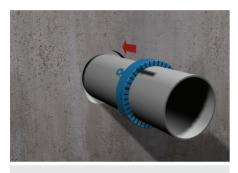
**4.** Im Anschluss ist die Brandschutzmanschette in die Öffnung in der Wand bzw. in der Decke zu schieben, bis der äußere Punkt des Metallgehäuses bündig mit der Wand/Decke ist. Bei Deckenanwendung ist die Manschette gegen Abrutschen zu sichern.
