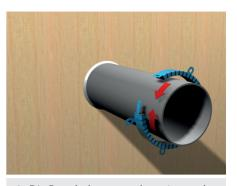
**3.** Die Brandschutzmanschette ist um das Rohr zu platzieren und der Verschluss zu schließen. Die Manschettenlaschen sind um 180° zu biegen.
