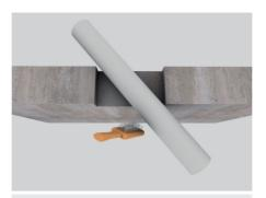
**1.** Das Rohr ist im Bereich der Schottöffnung zu reinigen, um eine glatte und staubfreie Fläche zu bekommen.
