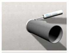
2. Wenn notwendig kann eine Schallisolierung montiert werden. Der maximal 15mm große Ringspalt ist im Anschluss mit Mineralwolle (Schmelzpunkt > 1.000°C), Gips, Mörtel, Beton oder PROMASEAL®-A auszufüllen.
