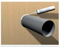
2. Wenn notwendig kann eine Schallisolierung montiert werden. Die maximal 15 mm große Lücke ist im Anschluss mit Mineralwolle (Schmelzpunkt > 1.000°C) zu stopfen und mit PROMASEAL®-A auszufüllen.
