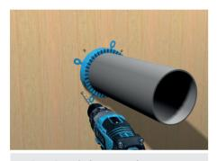
**4.** Die Brandschutzmanschette ist mit allen Laschen an der Wand oder an der Decke zu befestigen. Dazu ist ein Ø 6mm Bohrloch zu bohren und die Manschette mit 100mm langen Schnellbauschrauben und Unterlegescheiben zu befestigen.
