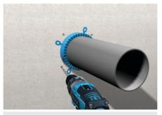
**5.** Die Brandschutzmanschette ist mit allen Laschen an der Wand oder im Boden zu befestigen.
