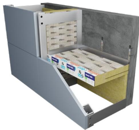
El producto está diseñado para su uso en fachadas ventiladas, con una cámara de aire lineal de 25 mm o 50 mm para permitir la circulación del aire y el drenaje de la humedad dentro de la fachada.
