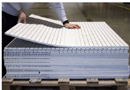
1) Plader med fræste riller "løsnes"
