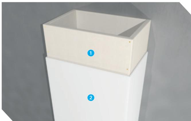
Fixation des plaques de plâtre ou des plaques PROMATECT®-100 directement sur le conduit au moyen de vis VBA. Cette mise en œuvre est possible uniquement pour les conduits verticaux.
