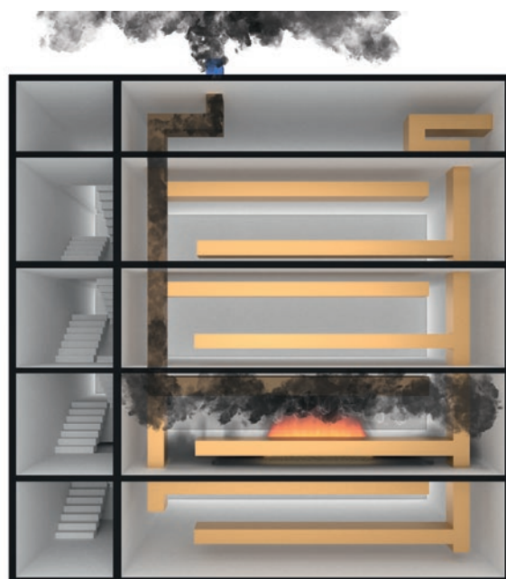
Schemat ilustrujący system oddymiający - przewody umieszczone wyżej są przewodami oddymiającymi, umieszczone poniżej stanowią przewody doprowadzające powietrze.
