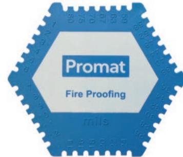
$$\text{D.F.T. } (\mu\text{m}): \frac{\text{WFT } (\mu\text{m}) \times \text{SVR } (\% \text{ de sólidos en volumen})}{100}$$
