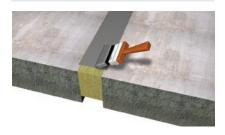
6. Aplique el correcto espesor de PROMASEAL®-A spray en la lana mineral de roca en la(s) cara(s) requerida (s) por ensayo y traslape 5 mm sobre el sustrato.
