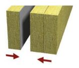
4. Dependiendo del ancho de la junta use la correcta cantidad de lana mineral de roca.
