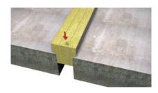
5. Comprima lana mineral de roca a 30% (punto de fusión100°C, Clase A1 Eurocode, densidad > 40 kg/m³) e inserte en la junta.
