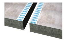
2. Si se requiere, enmascare a 10 mm el exterior de la abertura del muro o losa con cinta.
