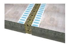
3. Comprima lana mineral de roca a 30% (punto de fusión100°C, Clase A1 Eurocode, densidad > 40 kg/m³) e inserte en la junta.
