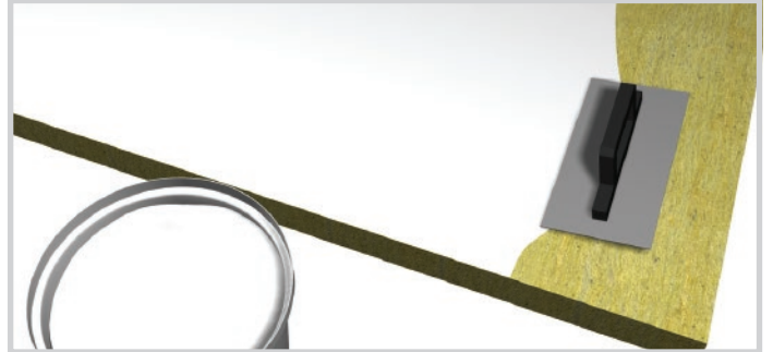
2. Aplique sobre la superficie de la lana de roca el espesor en húmedo de producto recomendado y considere tiempo para su secado
