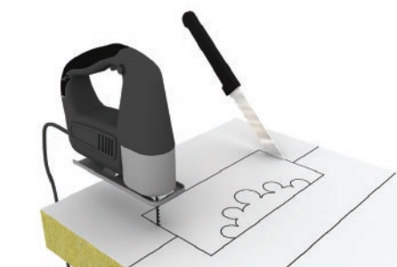
4. Corte la lana mineral exactamente a la medida. (Se recomienda el uso de caladora o equipo de corte).
