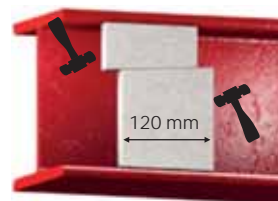
Montering av kil
