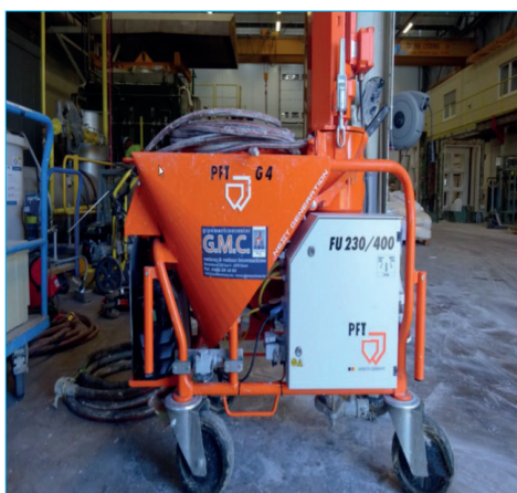
PFT G4 (malaxeur/pompe avec arrivée continue de matériau sec).
