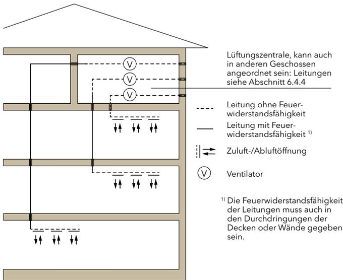
**Bild 1.4: Lüftungsanlagen mit getrennten Hauptleitungen und gemeinsamer Außenluft- oder Fortluftleitung mit Rauchschutz**
