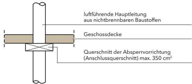
Bild 6.3: Schachtlösung für Lüftungsanlagen nach DIN 18017-3:2009-09
