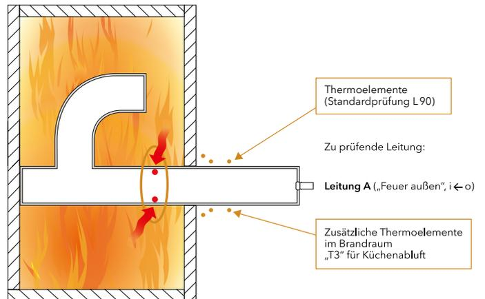
Brandprüfungen an Lüftungsleitungen:
