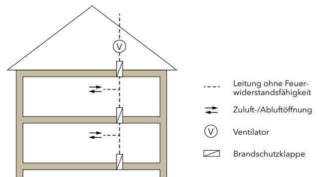
**Bild 2.2: Schachtlösung**
