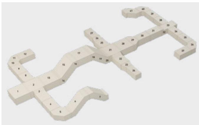
Schematische Darstellung: Positionen der Druckmessstellen am Promat-Leitungssystem
