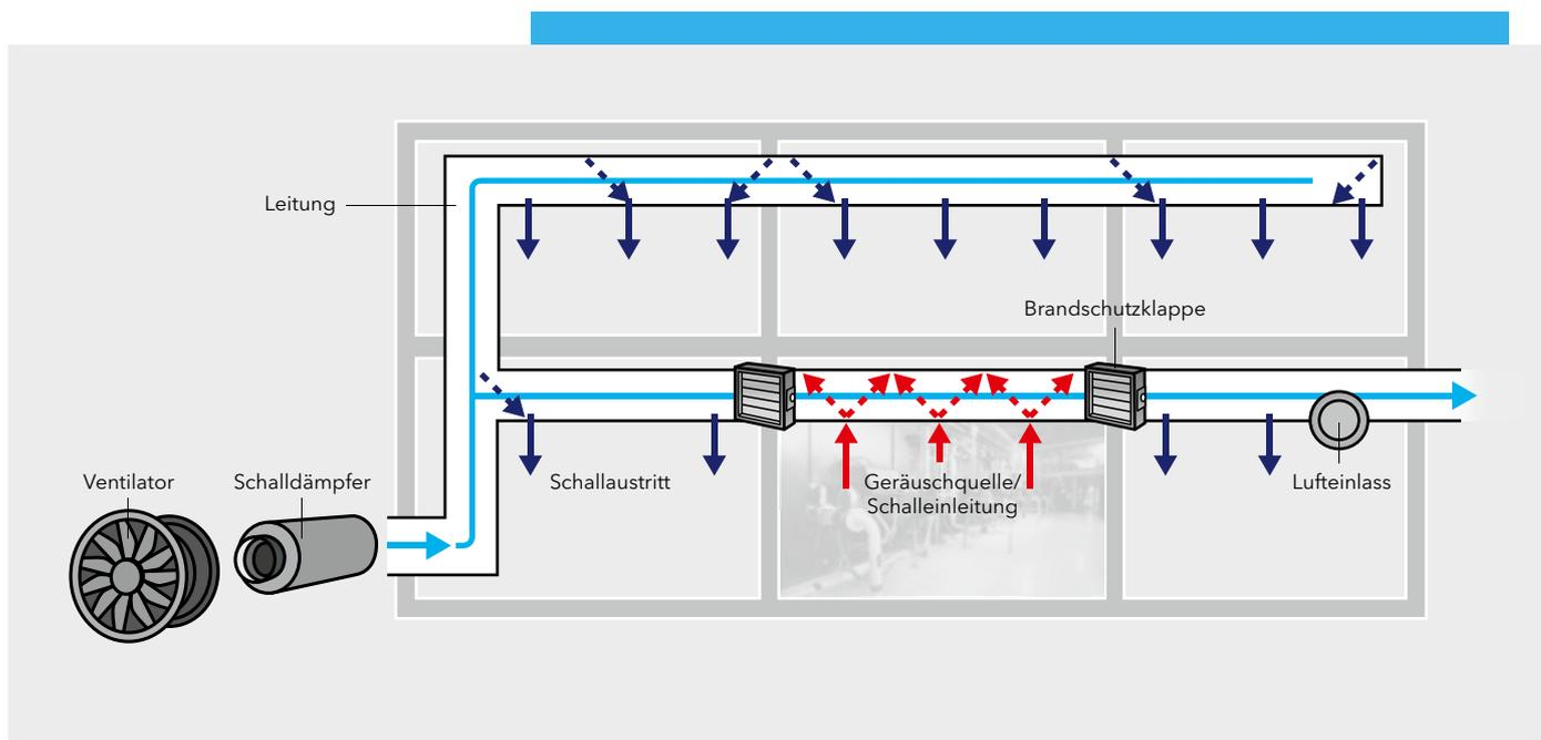
Eine Schallquelle, die innerhalb einer Lüftungsleitung Geräusche erzeugt, ist in der Regel der Ventilator.
