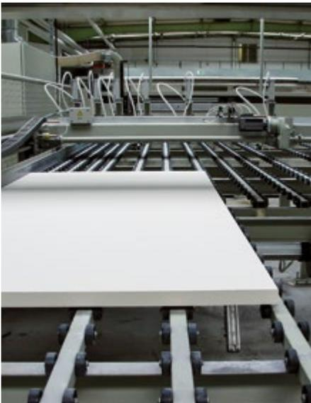
Plattenaufteilanlage für den Zuschnitt von Promat-Brandschutzbauplatten
