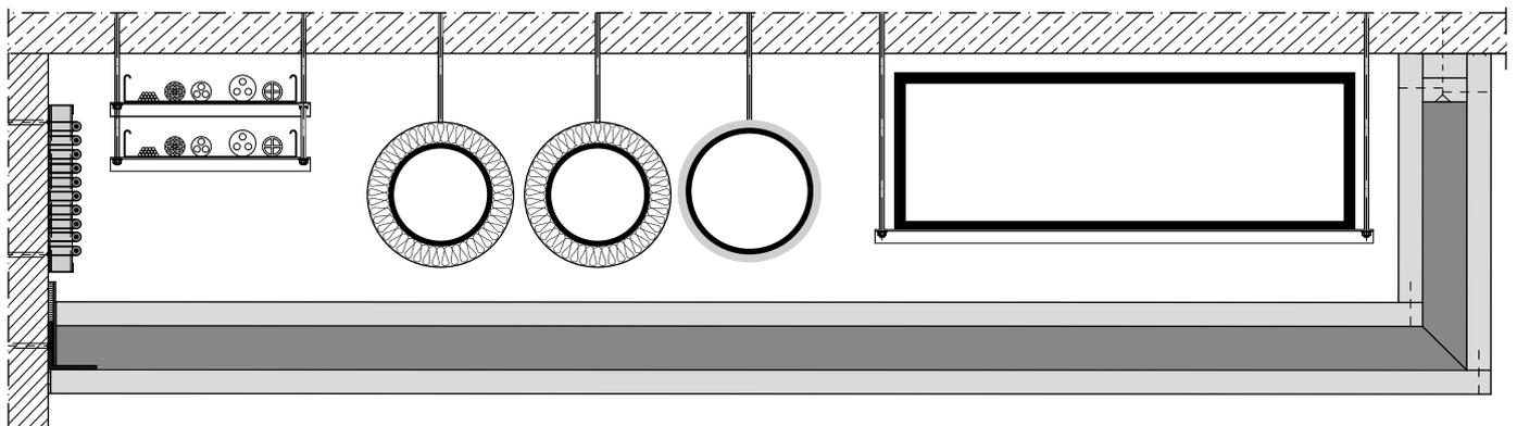
Abb. 2: zweiseitige Ausführungsvariante unterhalb von haustechnischen Installationen
