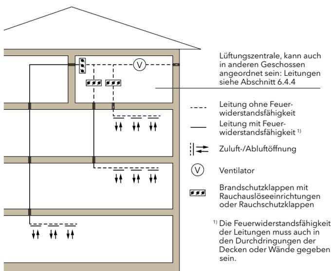
**1.2** Durchführung horizontaler Lüftungsleitungen durch raumabschließende Wände, an die Anforderungen hinsichtlich der Feuerwiderstandsfähigkeit gestellt werden.
