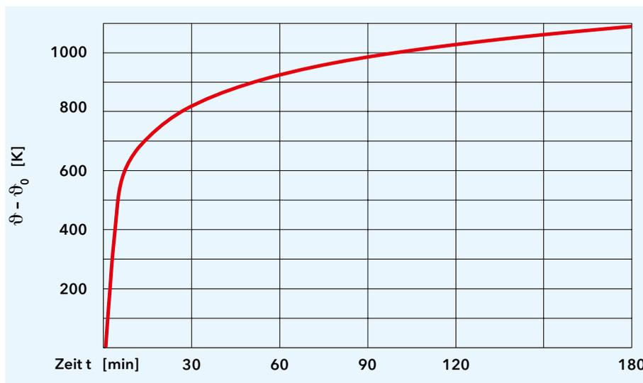
Abbildung 2: Einheits-Temperaturzeitkurve (ETK) nach DIN EN 1363-1
