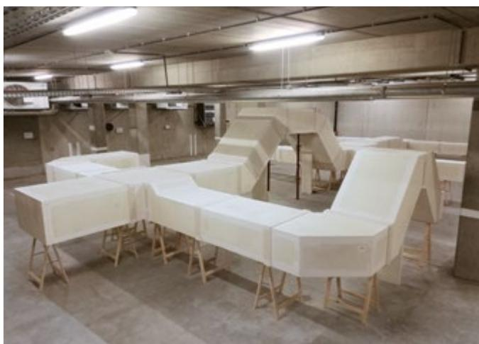
Messung von Druckverlusten an einem Promat-Leitungssystem
