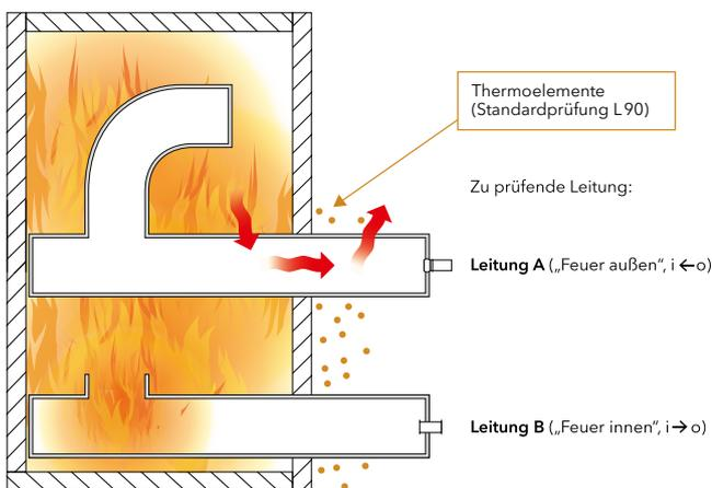
Brandprüfungen an Lüftungsleitungen:
