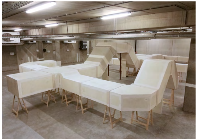
Messung von Druckverlusten an einem Promat-Leitungssystem
