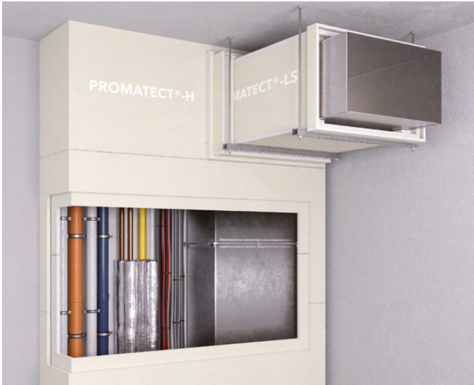
Abbildung 3: ABP P-3082304/14-MPA BS: Anschluss einer PROMATECT®-LS-Bekleidung für Stahlblechleitungen L 90 an eine PROMATECT®-H-Schachtwand F 90 (Promat-Konstruktion 478 und 450.41)
