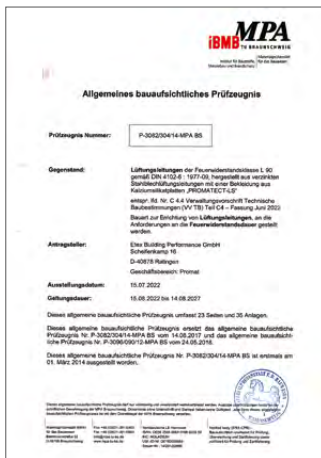
Abbildung 5: Beispiel ABP für Lüftungsleitung
