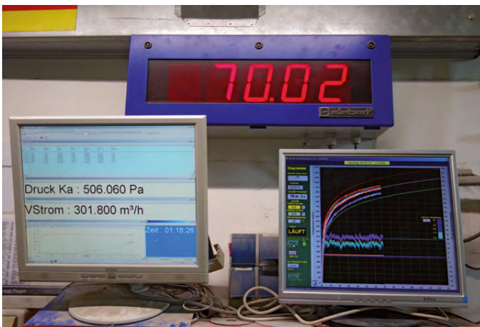
Steuerung Brandprüfung und Erfassung von Messdaten
