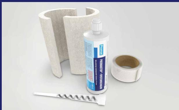
Das PROMASTOP®-EASYFIT-Set wird zur schnellen Ausbildung eines Öffnungsverschlusses in unterschiedlichen, raumabschließenden Bauteilen genutzt. Die vorgefertigte PROMATECT®-H-Rohrschale eignet sich sowohl als formbeständiges, nichtbrennbares Hüllrohr als auch zur Laibungsausbildung beim Einbau in Norm- und Sonderbauteile (z. B. Brettspernholzwände, leichte Trenn- oder Sandwichpaneelwände etc.)\*. Weitere Details zu den Anwendungsmöglichkeiten erhalten Sie auf Anfrage.
