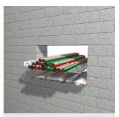
3. La primera fila de almohadillas debe ser instalada por debajo de los cables o tuberías.
