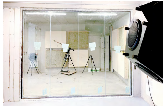
485.33 – Schallschutzprüfung EN ISO 10140-2, EN ISO 717-1
