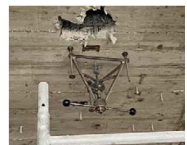
Dübelausziehversuch am Beispiel Fischer Langschaftdübel SXR10
