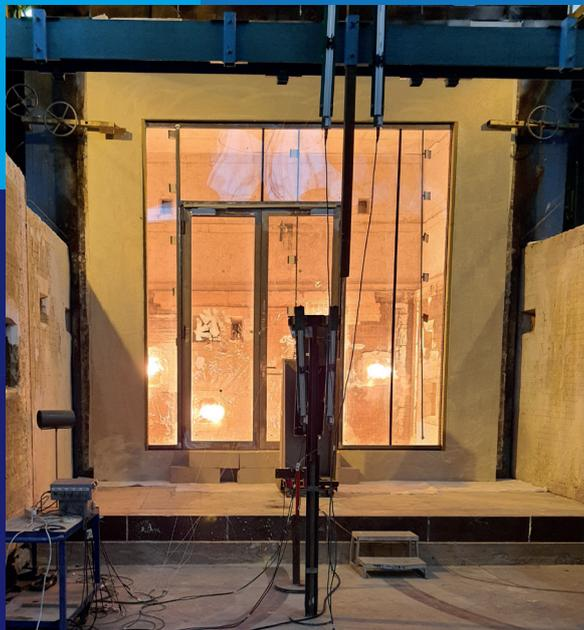
Les cloisons vitrées Promat®-SYSTEMGLAS F1 bénéficient d'une couverture d'essais de résistance au feu importante : EI 30 à EI 120.
