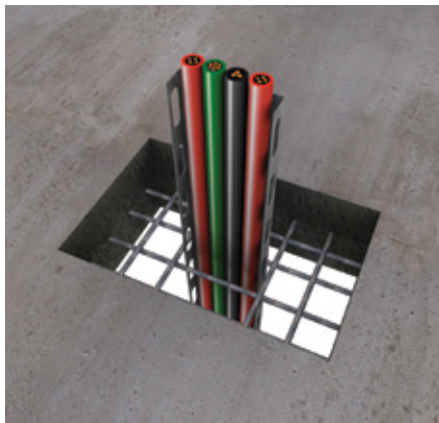
2. Za brtvljenje otvora u podovima, postavite željezne klinove. Ovi se klinovi moraju postaviti u središte u odnosu na ispunu mortom na svakih 300 mm, ali minimalno jedan željezni klin na svakoj strani, te u dubinu poda od 50 mm i ispunjeno s 50 mm PROMASTOPA®-M. Za brtvljenje na zidovima nisu potrebni željezni klinovi.
