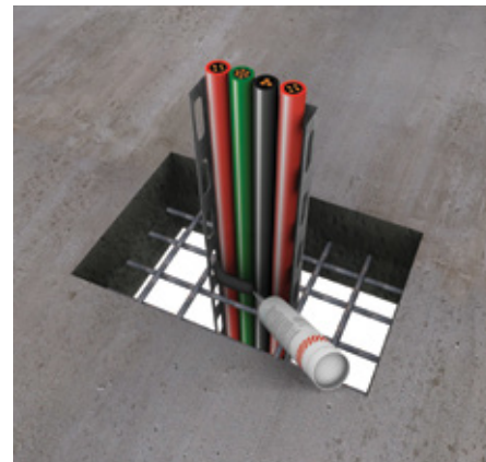
3. Nanosite PROMASEAL®-AG oko kablova i kabljskih snopova.
