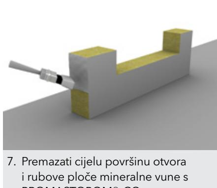
7. Premazati cijelu površinu otvora i rubove ploče mineralne vune s PROMASTOPOM®-CC.
