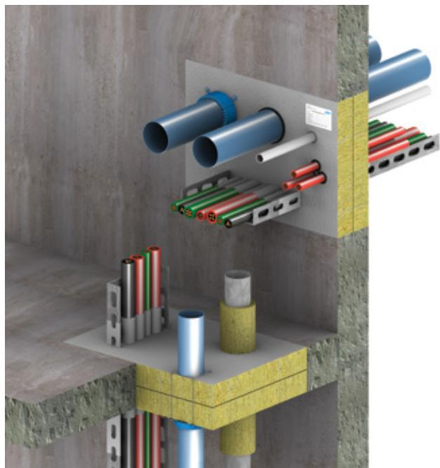
PROMASTOP®-CC je 'hibridni' protupožarni premaz na bazi vode, koji kombinira pozitivna svojstva intumescentnih i ablativnih premaza. Na području protupožarnih otvora, PROMASTOP®-CC osigurava pouzdanu zaštitu od širenja dima, vatre i vrućine zbog učinka stvaranja pjene i istodobnog stvaranja tvrde i krute čađe.
